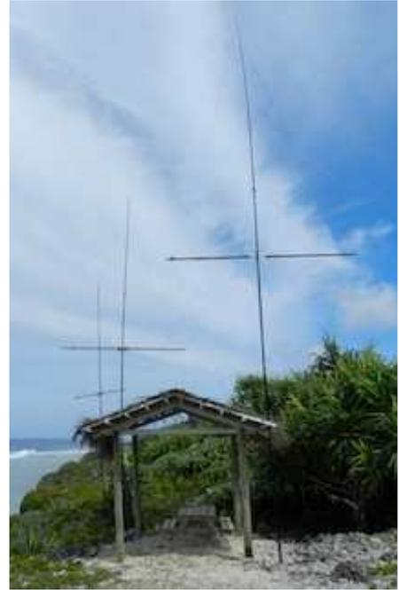
On peut faire encore mieux en en alignant quatre comme KG0D pour une yagi verticale 4 él. Toutefois, pour nous, en dehors de la 4Sq, c'est 2él vert. avec une alimentation en phase. Dans ce cas, les dipôles sont sur la même fréquence de résonance et il faut appliquer la recette des calculs d'ON4UN. De fait, on peut dire aussi qu'il s'agit grosso modo d'une HB9CV avec les extrémités rapprochées. A peine un peu moins de gain.
