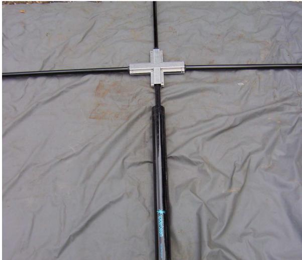
Pour faire une loop verticale (ou autre 2él), un kit composé d'un croisillon (~ 25cm) et de deux cannes de 4m (Ø 22mm) est proposé (soit pour h~ 8m du sol) ainsi qu'une gamme d'accessoires (colliers, haubans, isolateurs ect). Ceci permet d'obtenir un carreau de Quad 20m.
