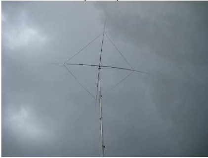
Photo : F6BKD Dipôle replié 14MHz @ 15m
