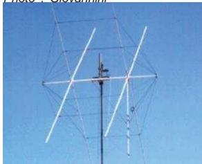
Le modèle c25/2 était conçu pour résister à des vents de 160km/h grâce à un haubanage pour le moins élaboré. Ne semble plus au programme.
