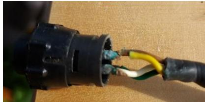
La goutte d'eau de condensation se fixe entre la soudure et la gaine du fil multibrins. Elle corrode et dévore les fils... Ce n'est qu'une question de temps selon l'environnement plus ou moins agressif.
